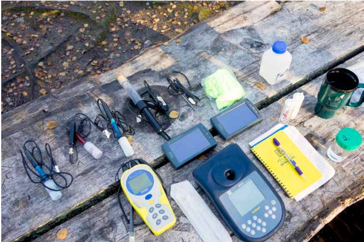
Kuva 3. Kenttälaboratorio Haukkajärven rannassa Hannukurussa. Ylärivissä kaksi Vernierin pH-anturia, orp-anturi, happipitoisuusanturi ja lämpötila-anturi. Keskellä kaksi Vernier Labquest2 tiedonkeräintä. Alarivissä Aquashock Water Purity mittari ja YSI 9300 fotometri. Vesinäytteet keräsimme vihreäkantiiniin purkkeihin (oikealla) ja pakastuspulloihin (oikeassa yläreunassa). Näyteastioiden välissä BioPaddlet.
